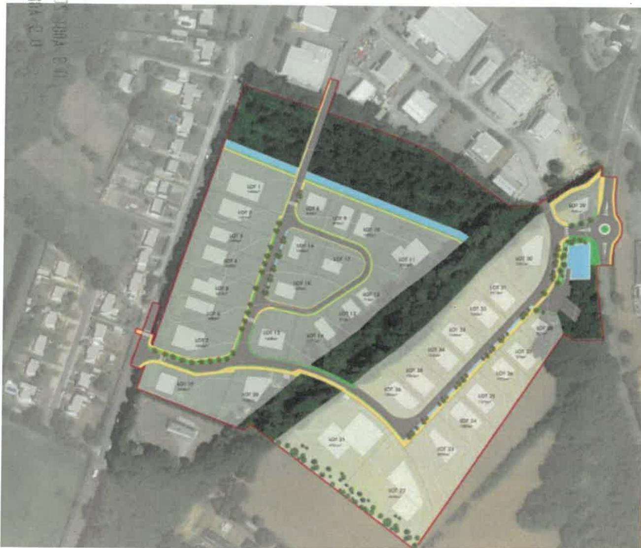
En bleu clair, les ouvrages de rétention des eaux pluviales.
